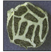
рис.3. Срез 5 жгутов PERMACURE, которые завулканизировались вместе, образовали единый монолит.
