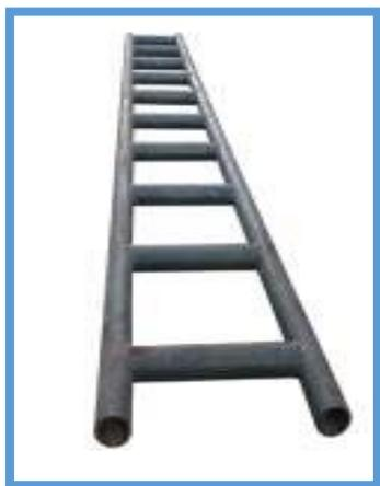
Лестничные балки для обеспечения свободного пространства между лесами. 305 мм глубиной и 305 мм от центра к центру перекладины. Изготовленные из стальных труб с внешним диаметром 48,3 мм и толщиной 3,2 мм или 4,0 мм, приваренные к каждому стыку, они полностью интегрируются с существующими системами крепления.
